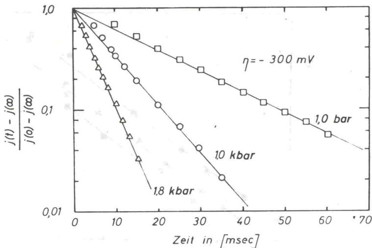
Abb. 22. Differenz zwischen den Strömen  $j(t)$  zur Zeit  $t$  und dem stationären Strom  $j(\infty)$  beim potentiostatischen Einschalten einer konstanten Überspannung von  $-300 \text{ mV}$  für die Wasserstoffabscheidung an Kupfer aus  $0.5 \text{ m}$  Schwefelsäure.
